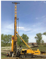
Рис. 198. Машина для забивания свай
